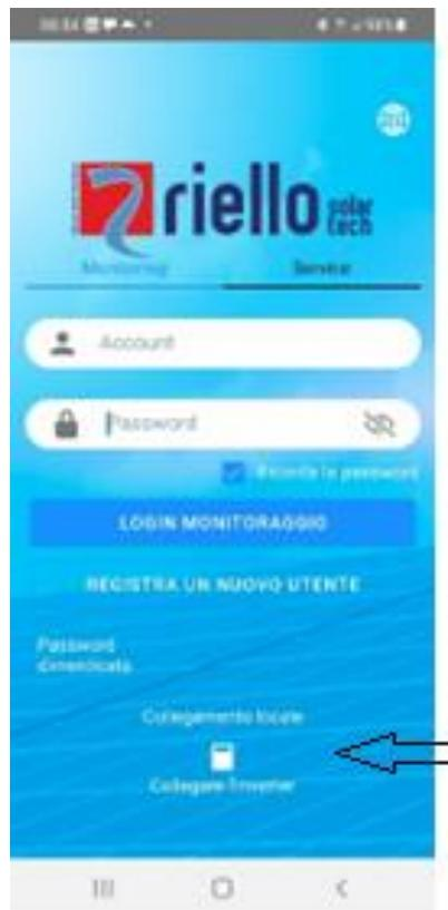
2. Fare scansione del codice a barre posto sull'etichetta laterale sull'inverter, oppure selezionare tramite "Manual Connection" il proprio inverter (se presenti più inverter sul posto le ultime 3 cifre del codice che compare sull'app corrispondono alle ultime 3 cifre della matricola inverter).
